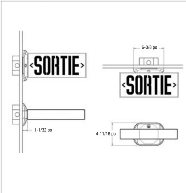
Le pavillon de recouvrement EZ2 permet à l'installateur de réaliser toutes les connexions électriques à l'aide de ses deux mains, sans avoir à jongler avec l'enseigne de sortie. Ceci en fait un produit axé sur l'entrepreneur, d'une convivialité sans précédent.
