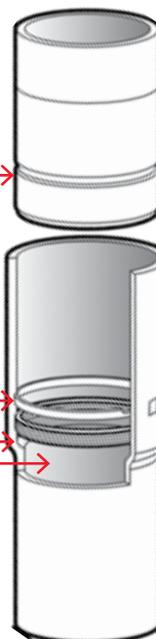
Indicateur de profondeur d'insertion pour savoir à l'œil si les bouts des conduits sont insérés à une profondeur appropriée
