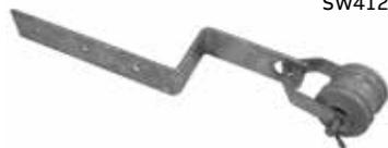
Si l'isolateur n'est pas requis, ajoutez le suffixe « NI » au numéro de catalogue. Support pour pose au mur ou sous avant-toit fabriqué d'acier  $\frac{3}{16}$  po x  $1\frac{1}{2}$  po; isolateur-poulie IB134 inclus; trois trous de montage ronds  $\frac{3}{8}$  po. Pièces ferreuses galvanisées par trempage à chaud.
