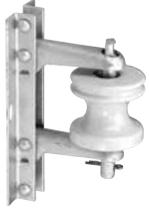
Les supports sont construits de fer angle de 1 x 1 x ¼ po avec isolateur-poulie monté sur une tige de ¾ po diamètre retenu par une goupille fendue en laiton de ¼ po. Pièces ferreuses galvanisées par trempage à chaud. L'isolateur-poulie IB135 doit être commandé séparément (inclus avec le support SS401E seulement).
