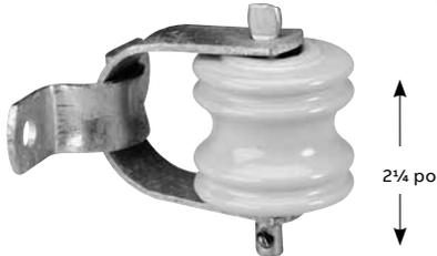
Si l'isolateur n'est pas requis, ajoutez le suffixe « NI » au numéro de catalogue. Construction d'acier  $\frac{3}{8}$  po x 1 po; goupille à pivot  $\frac{3}{8}$  po diam.; isolateur-poulie IB134 inclus; deux trous de montage ronds  $\frac{7}{16}$  po. Pièces ferreuses galvanisées par trempage à chaud.
