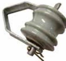
Si l'isolateur n'est pas requis, ajoutez le suffixe « NI » au numéro de catalogue. Construction d'un profilé en acier  $1\frac{1}{4}$  po x  $\frac{1}{2}$  po x  $\frac{1}{8}$  po; goupille  $\frac{5}{8}$  po diam.; isolateur-poulie IB135 inclus; trou de montage rond  $1\frac{1}{4}$  po. Pièces ferreuses galvanisées par trempage à chaud.
