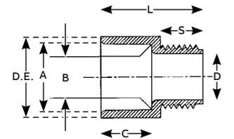
Servent à adapter les conduits non métalliques aux boîtes, raccords filetés et systèmes métalliques. Filets mâles à un bout, douille à l'autre bout.
