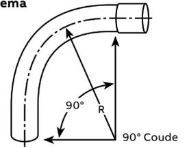
Ces coudes, de modèles ordinaire et à bout à cloche d'emboîtement intégrée, s'utilisent avec les raccords non métalliques à soudage par solvant. Des coudes d'autres dimensions peuvent être fabriqués sur commande.
